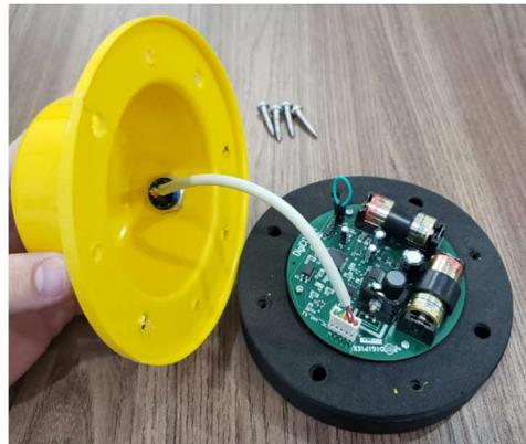
**Passo 3** - Identificar a barra de pinos com 5 pinos onde é possível verificar um jumper no pino 1 com o negativo da placa conforme imagem abaixo e removê-lo.
