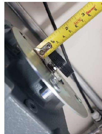
Distanciamento da ponteira do encoder (20mm do redutor)
