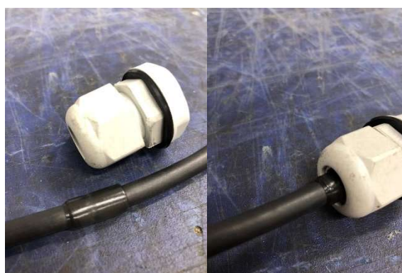
Figura 3- Demostración de cómo hacer engrosamiento con cinta aislante
