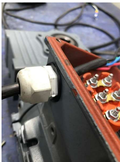
Figura 1- Instalación correcta del prensaestopas
