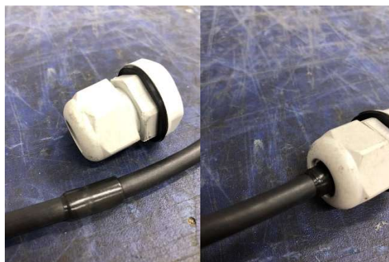
Figura 3- Demonstração de como fazer o engrosso com fita isolante
