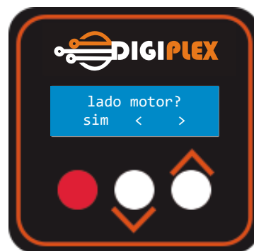
Figura 10 - Menu de Ajuste do lado do motor
