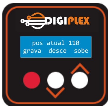
Figura 17 - Gravação da posição da porta Figura 18 - Confirmação da opção desejada
