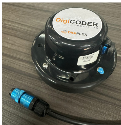
Imagem 28 – Conjunto DIGICODER: cabo de comunicação, ponteira e dispositivo
