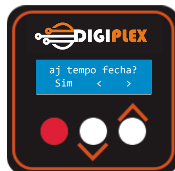
Figura 23 - Menu de Ajuste do Temporizador (TPFECHA)
