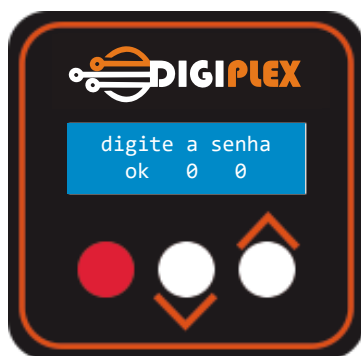
Figura 7- Validando a senha de instalador
