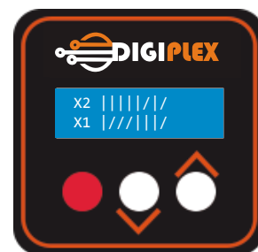
Figura 33 - Estado das entradas e saídas
