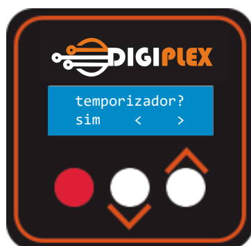
Figura 21 - Menu de Ajuste do Temporizador
