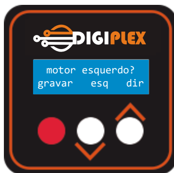
Figura 12 - Gravação do lado do motor
