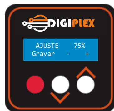
Figura 31 - Ajuste da Sensibilidade do looping
