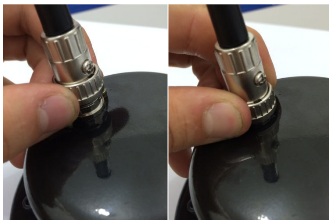
Figura 5 - Travamento da arruela do conector
