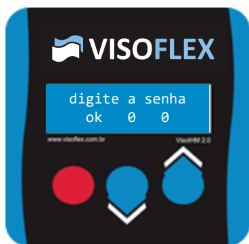
Figura 7- Validando a senha de instalador
