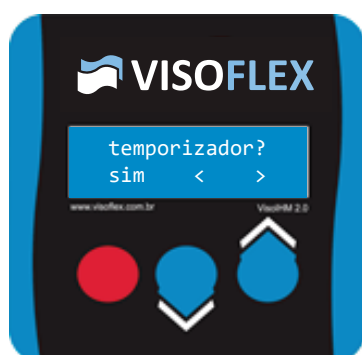
Figura 21 - Menu de Ajuste do Temporizador
