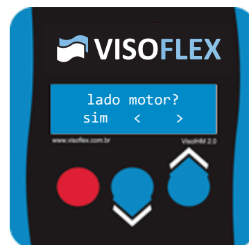
Figura 10 - Menu de Ajuste do lado do motor
