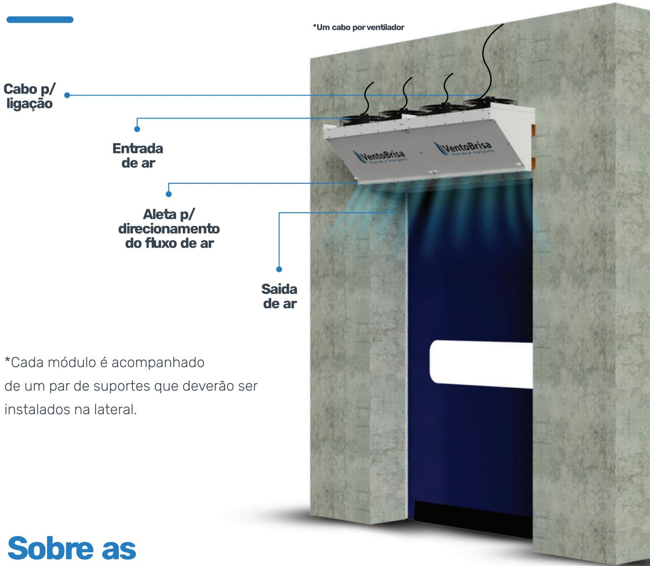
\*Cada módulo é acompanhado de um par de suportes que deverão ser instalados na lateral.
