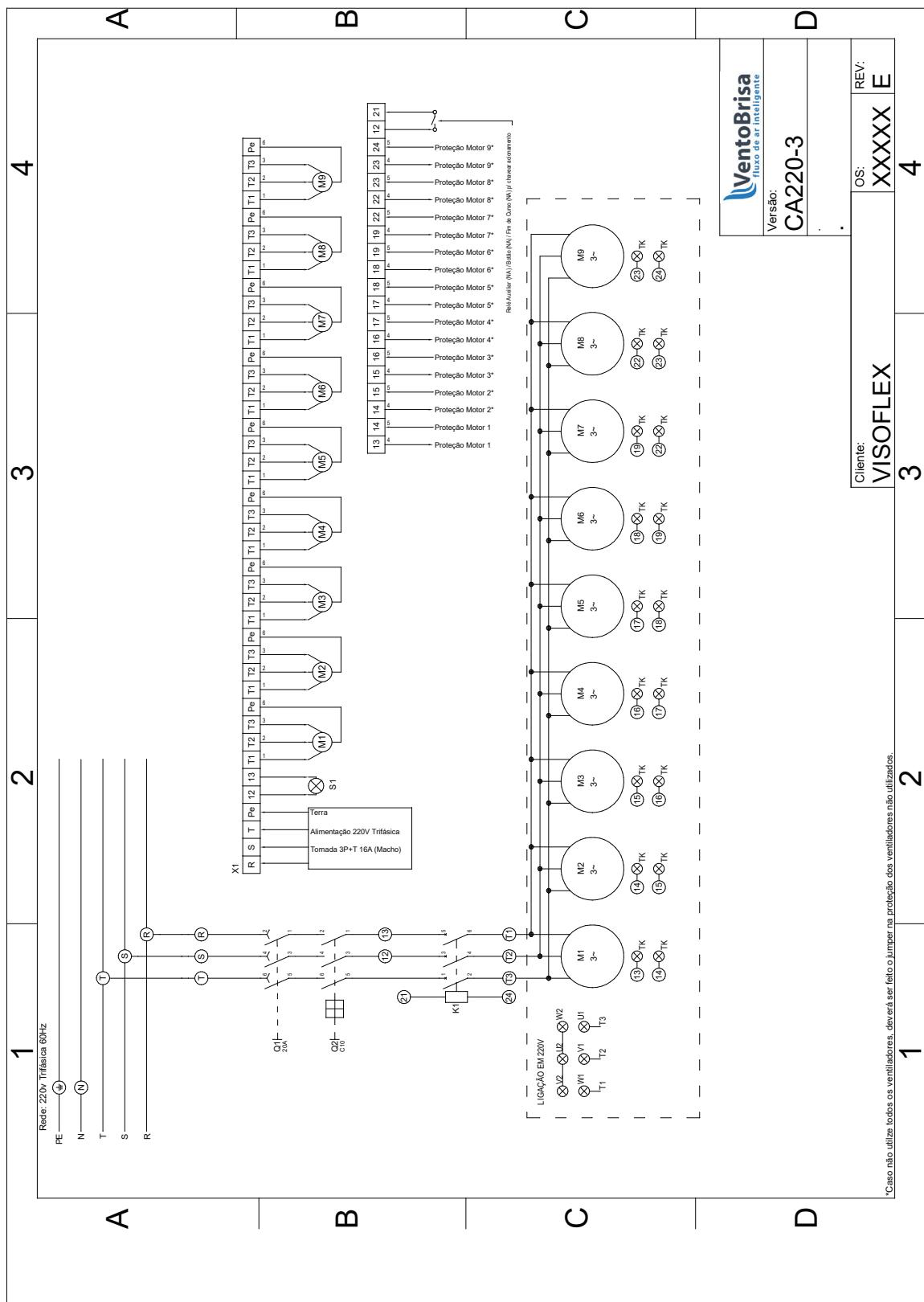
“Caso não utilize todos os ventiladores, devá ser feito o jumper na proteção dos ventiladores não utilizados.
